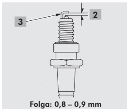
3. Inspeção dos eletrodos e a porcelana central quanto a depósitos, erosão ou carbonização. Se forem excessivos, troque a vela. Para limpar velas carbonizadas, use um limpador de velas ou escova de aço.
