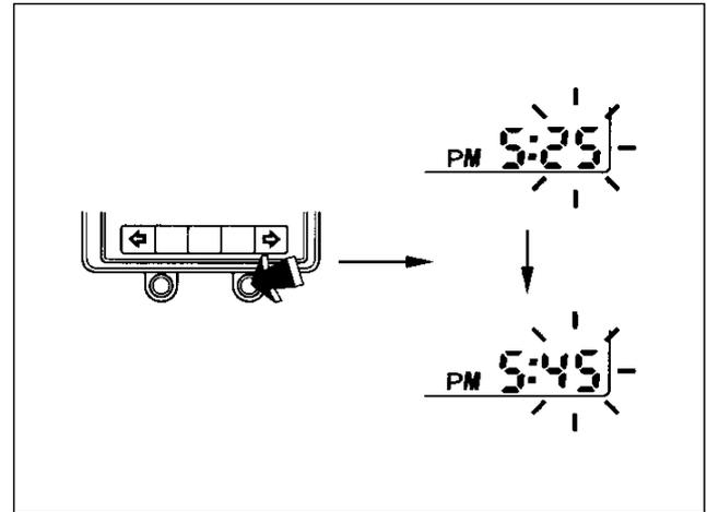
4. Espere aproximadamente 10 segundos. O mostrador pára de piscar automaticamente. O ajuste pode ser cancelado quando o interruptor de ignição for desligado com o relógio posicionado no modo ajuste.
