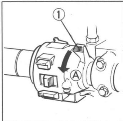
4. Tirer le levier de starter (1) à fond en arrière pour la mettre en position d'ouverture complète (A) si le moteur est froid.
