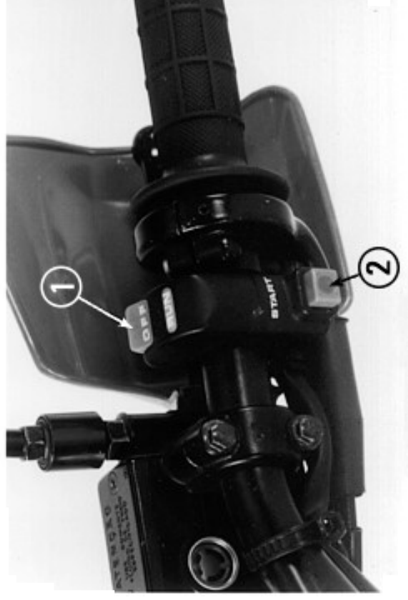
(1) Interruptor de emergência (2) Interruptor de partida
